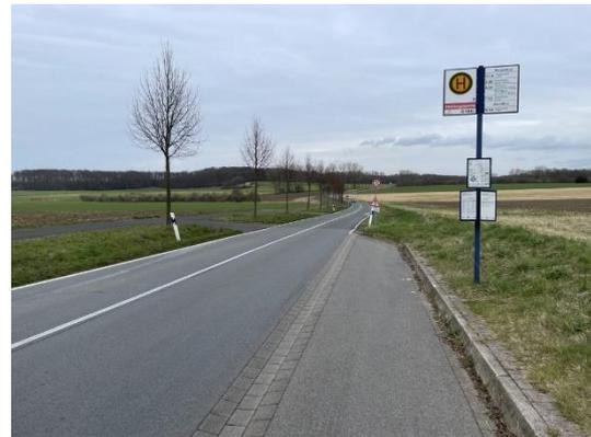
Abbildung 96: Fehlende Wartefläche und fehlender Fahrgastunterstand (Haltestelle „Straßengabelung“)
