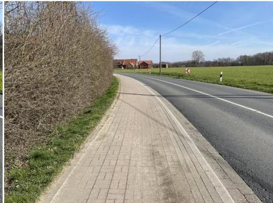
Abbildung 89: Fehlender Sicherheitsraum zwischen der Radverkehrsanlage und der Fahrbahn (Netteberger Straße | K8)
