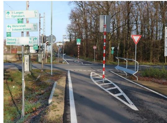
Abbildung 81: Beispiel für eine gute Absperrung eines Radweges vor dem Kfz-Verkehr und gleichzeitige Fahrbahnteilung<sup>29</sup>
