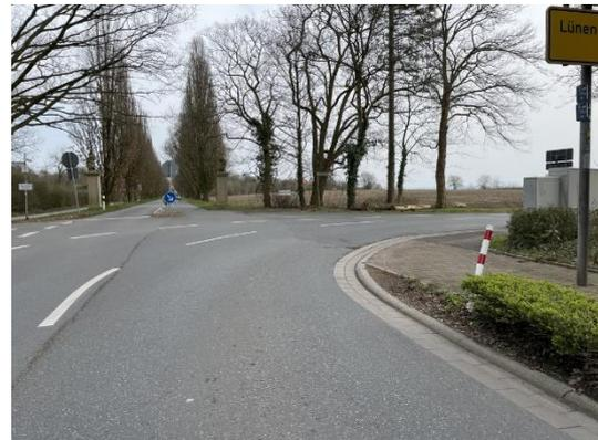
Abbildung 87: Sichtbehinderung durch einen Strom-/Verteilerkasten im Kreuzungsbereich (Freiherr-vom-Stein-Straße/ Am Brauereiknapp)
