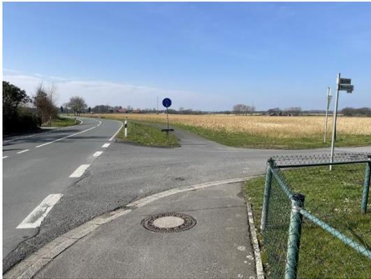
Abbildung 71: Fehlende Furtmarkierung im Zuge eines benutzungspflichtigen Geh-/Radweges (VZ 240)
