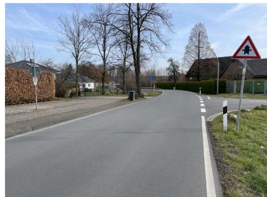
Abbildung 74: Fehlende Querungsanlage am Anfang/ Ende eines Geh-/Radweges (Südkirchener Straße/ Steinkamp)
