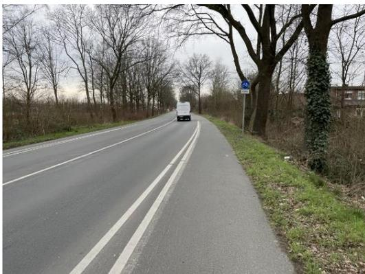
Abbildung 54: Fehlender Geh-/Radweg und Querungsanlage an der Münsterlandstr. (Mangel Nr. 79)
